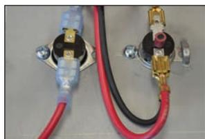
En cas de surchauffe, une protection thermique à réenclenchement automatique éteindra les éléments chauffants. Pour un niveau de sécurité accru, une deuxième protection thermique, celle-ci à réenclenchement manuel, sera activée si la première venait qu'à être défectueuse.
